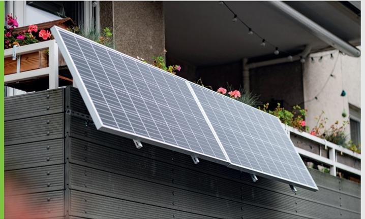
Balkonkraftwerke sind speziell für den Einsatz auf Balkonen oder Terrassen konzipiert und bieten eine platzsparende Lösung, um nachhaltig Energie zu gewinnen. Das kompakte Design ermöglicht eine einfache Montage und passt perfekt in jede Wohnsituation.
